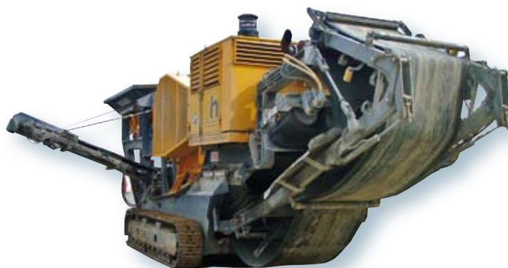
*Concasseur à mâchoires HARTL Powercrusher PC 13/80 J, 2005, 2 convoyeurs, séparateur magnétique, commande à distance
